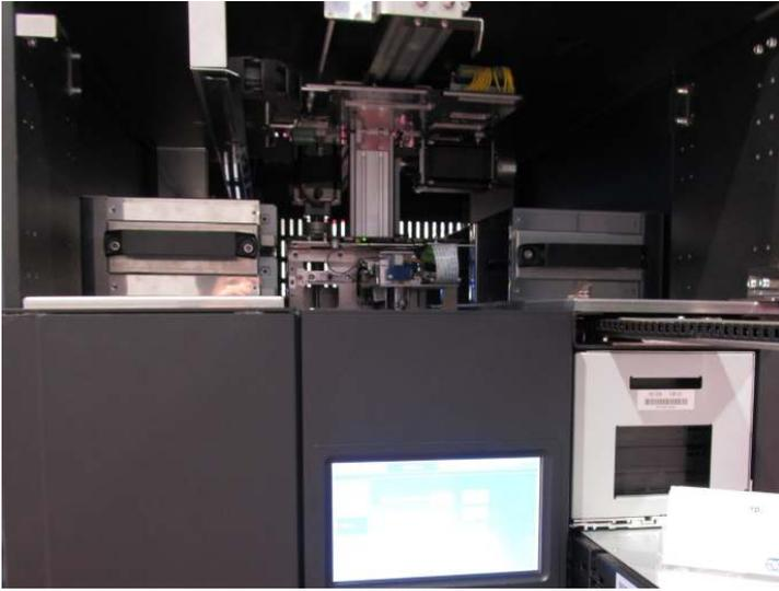
ライブラリーの左右にカートリッジとドライブが配置され、中央を搬送機構が移動し、メディアの移動を行います。カートリッジ前面が平らなため、搬送機構は常に最短距離で移動出来ます。カートリッジは、それが上下左右に6個ずつ搭載された細長いマガジンを引き出すことで交換が可能です。カートリッジの総数は720個です。内蔵ドライブは、上部に左右に6台ずつで合計12台の通常サイズのドライブを搭載出来ます。1個のカートリッジに入っている12枚のメディアから任意の枚数のメディアを複数のドライブに搬送出来ます。
